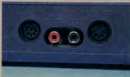
◆カセットとテレビ用のコネクタ。コネクタとは、複数の電気回路を結んだり、離したりする機械部品のことである
