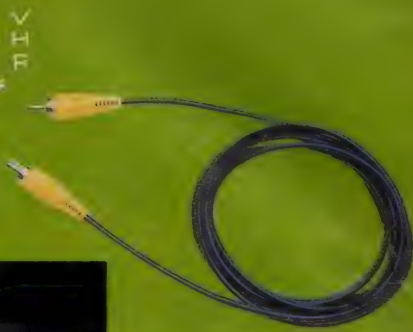
↑市販されているビデオコネクタの片端をアンテナ端子に、もう一端をRFアダプタに接続する。
