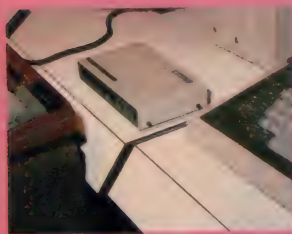
上: プロセッシングユニットMP-401 右: 内蔵される基板。質の高い音楽にも 対応できるように専用のCPUを使 ってパソコンからの命令を処理する。
