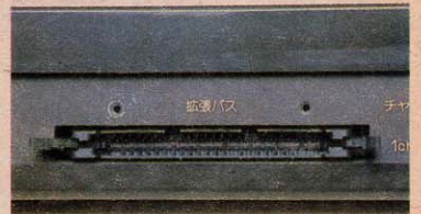
■本体後部の拡張バスコネクタ。普段はピス2本で固定されるカバーがつく。
