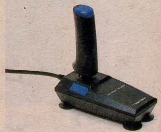
■ジョイスティックHX-1J400。裏の4つの吸盤で机上に固定可能。
