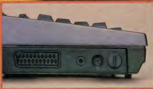
↑左から順にRGB、VHSYNC、VTR、BALANCE。
