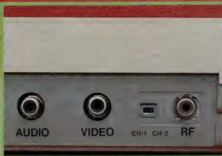
↑左から音声、映像端子。右はRFモジュール。
