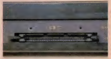
●本体後部の拡張バスコネクタ。普段はピス2本で固定されるカバーがつく。
