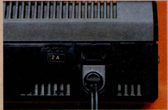
↑後面に用意されたACコンセント。100V、2A。
