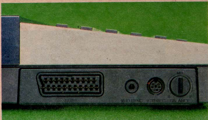
■本体に納めたスーパーインボーズユニット。大きな四角のコネクタがEIAJのRGB
