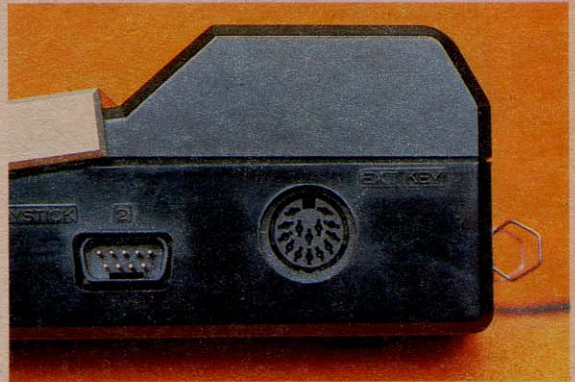
↑大きな丸形のHEXテンキー接続コネクタは側面。
