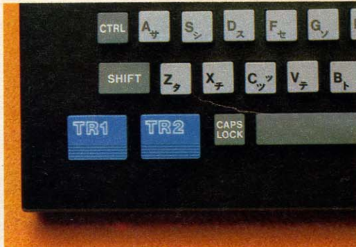
◆ゲーム専用に設けられた、2つのトリガーボタン。ジョイスティック用のSTRIG 関数に対応してつくられている。
