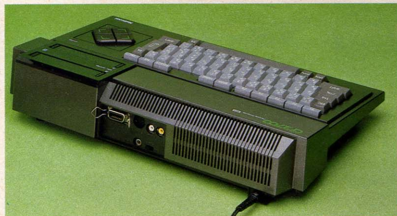
◆後ろから見たショット。電源部の放熱を考え、スリットがかなり広範囲にわたって切られている。前から見たときはそれほど感じなかったのだが、この角度から見るとマシンのボリューム感をおわかりいただけるだろうか。これを、「重い」と感じるか、「安定感がある」と感じるかは人それぞれだが、1クラス上のマシンのイメージだ。
