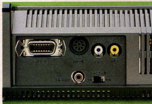
◆後面中央に設置された接続端子。何度も抜き差しするものではないので、1カ所に集中させるのもひとつのアイデアだろう。
