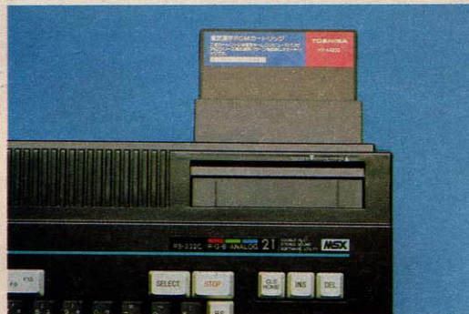
◆こんな使い方が一般的になる!? リアスロットに漢字ROMカートリッジを差したところ。これで日本語ワープロの完成だ。
