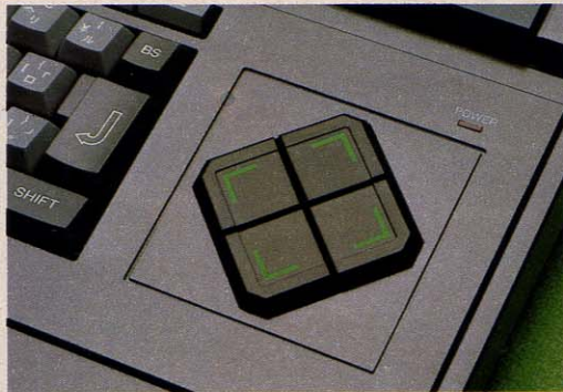
◆緑の矢印がポイントのカーソルキー。□と□のキーが接近しているため、素早いキー操作もとまどうことなくこなせる。
