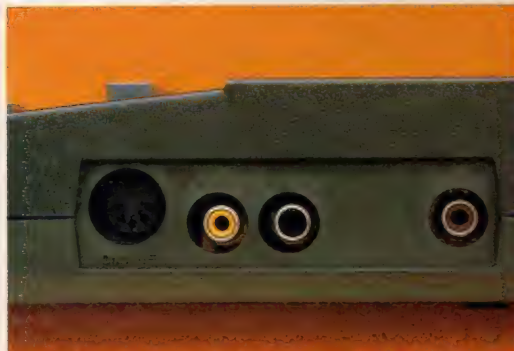
◆オプションのカセットインターフェイスを、左のCMTポートに接続する。中央が映像・音声出力、右がRF出力の端子群。
