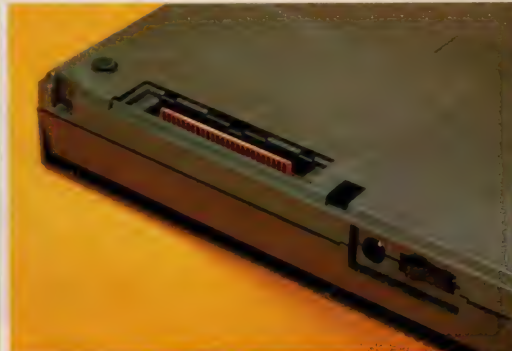
◆本体底面の拡張コネクタ。スロットの裏側に位置し、拡張ボックスとの接続に利用する。使わないときはフタがつく親切設計だ。
