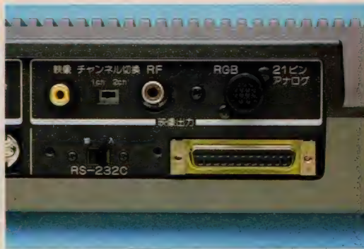
◆下にある平たいコネクタが、RS-232Cインターフェイス。映像出力はRFからRGB21ピンまで、すべてに対応しています。
