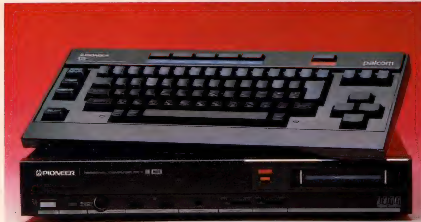
▶MSXパソコンと拡張プロセッサをつなげるためのコネクタ。右側には拡張スロットも用意され、各種ソフトも使用できる。
