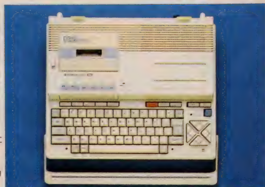
本体にはMB-H1と同様にキャリングハンドルが付く。本体後半部(カセットメカ、電源部など)はかなりのボリュームがある。
