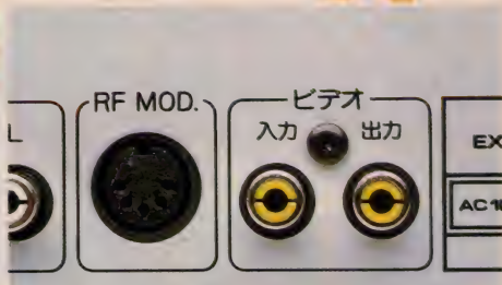
▶オプションのRFモジュレータをつなげるためのRF MOD端子。右はビデオの入・出力端子です。
