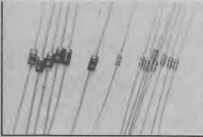
ダイオード。左が整流用(10D-1)、右がスイッチング用(1S1588)のシリコンダイオード。
