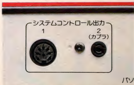
▶レーザーディスクをコントロールするための、システムコントロール出力端子。LD-7000などとつなげます。
