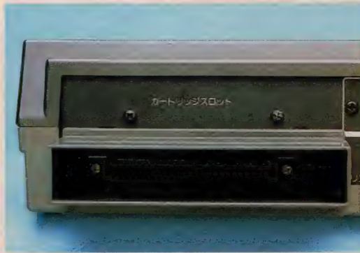
◆本体後部のカートリッジスロット。カバーは取り外しできるが、カートリッジが不安定になるので、外さない方が無難です。
