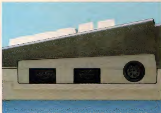
◆本体右側面のジョイスティックポートと、カセットインターフェイス。キートップにスロープがついているのがわかるかな。
