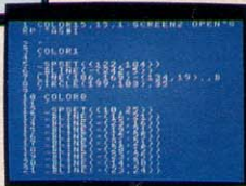
ライトペンで描いたグラフィックスを、BASICプログラムに変換して、モニター画面に表示。
