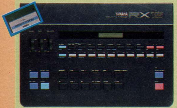
◆ヤマハのPCMドラムマシンRX15。MIDIを使えばDX7などの鍵盤楽器からもコントロール可能。定価79,800円
