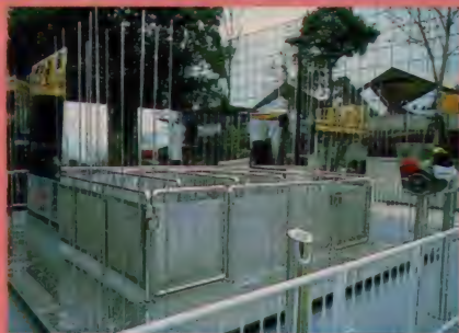
▲マグニチュードの床 水平2方向の地震の波を人工的に再現し、マグニチュード2~7の地震を体験する装置。ステンレスのミラー棒と板で揺れを確認する。
