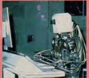
▲テーマ館のロボットは、早稲田大 学加藤研究室作。1秒間に15回とい う速さで鍵盤を打つ。バッハからビ ートルズまで、指示された曲を演奏。
