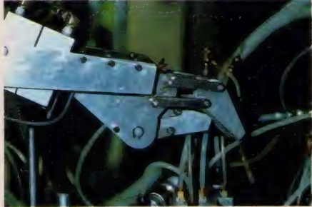
▲これがAsshyの手。はさむようにして物をつかむことができる。▲味けないこの箱が頭。顔の面にはダイオードが整然と並び、作動時の状態をモニター。ここには握力センサーが入っていて物をつかむ力をコントロール。する。また頭上には、超音波センサーが配列されて、天井までの距離を測る。
