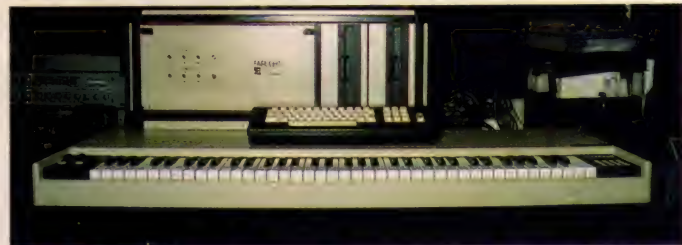
↑フェアライトCMI ライトペンによる波形合成、サンプリング可能。
