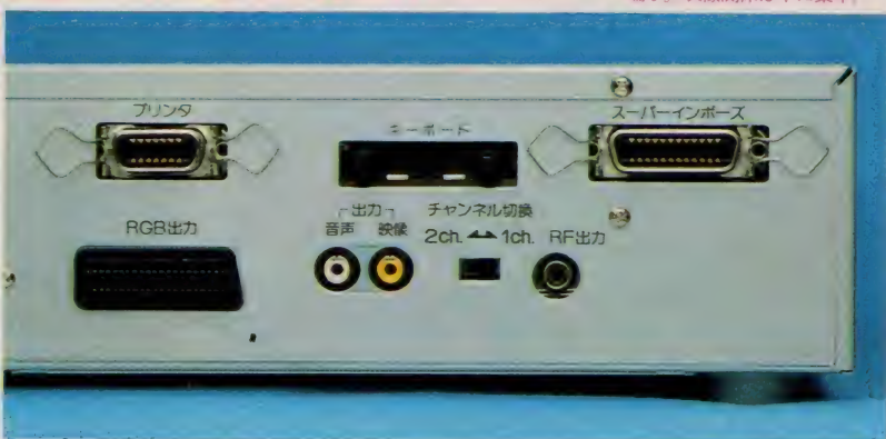
↓左からプリンタIF、キーボード端子、スーパーインポーズ端子。映像関係は下に集中。
