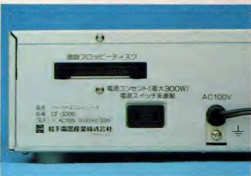
↑上にあるのが増設ディスク用の端子。電源コンセントもある。
