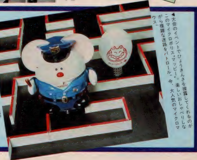
◀競技用迷路走行と床面に銀テープを貼ったランドマークセンス走行どちらでも可。銀テープに対して垂直に姿勢制御しながらの走行と、沿線走行の両方ができる。
