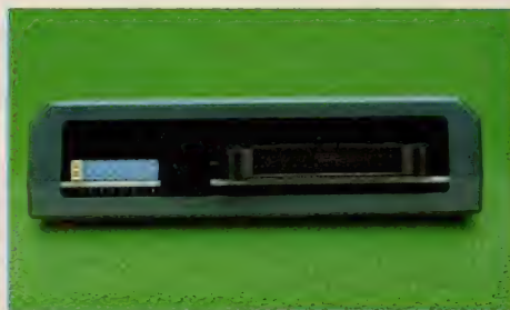
●カートリッジ上部に設けられた、26ピンコネクタに外部機器を接続する。その左にあるのは、ジャンパースイッチだ。
