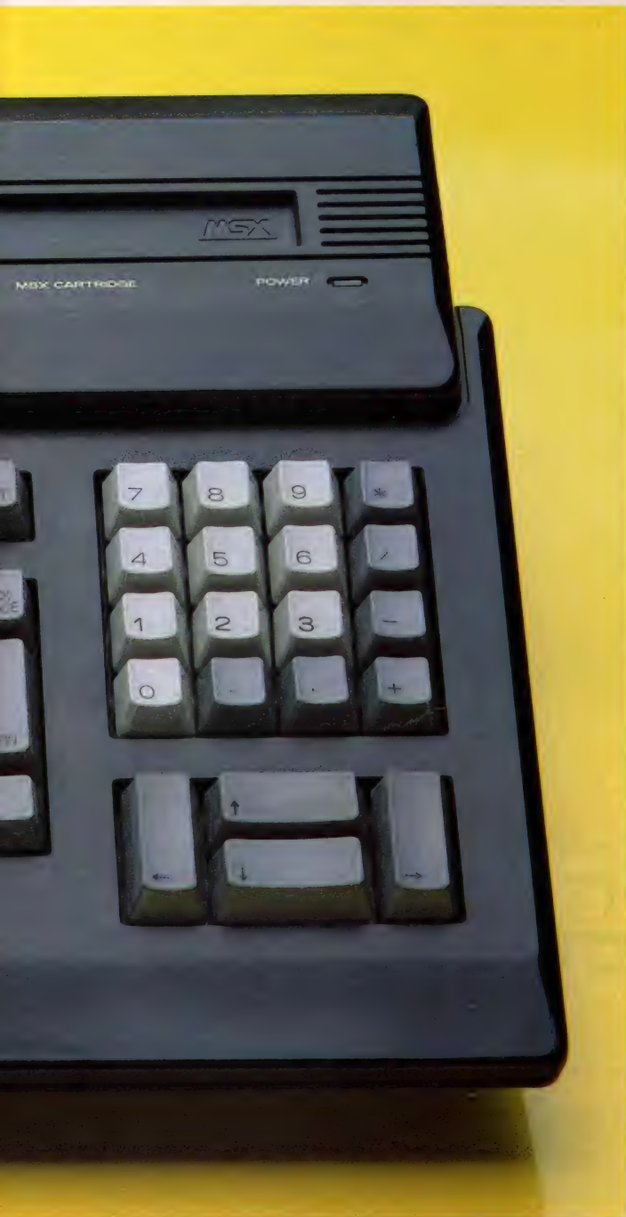
◆マシンの右側面。左のリセットスイッチを間違えて押さないように、左右に突起が設けられている。
