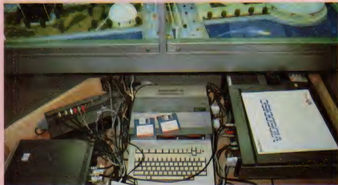
◆LDを使ったIVSシステムの内幕。ソニーのSMC-70が使われている。
