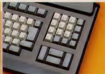
◆算術記号とカンマ、ピリオドも付いた10キー。これにより、データ入力に要する労力が飛躍的に減る。
