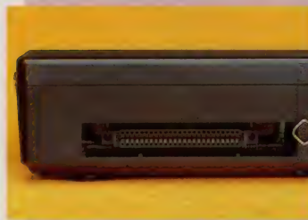
◆本体右後面に設けられたカートリッジスロット。FDのインターフェイスなど、抜き差しのないものを。
