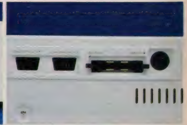
◆キーボードやデータレコーダ、ジョイスティック等の接続端子は、すべて本体側面に内蔵されている。
