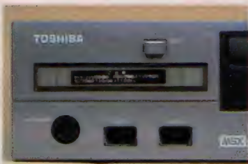
◆カートリッジ・スロットは、前面パネルの他後面にも設けられている。左下はキーボード・コネクタ。
