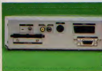
◆ドライブの拡張はこの端子から。MSXではドライブBに相当する。RGB出力はアナログ21ピン対応
