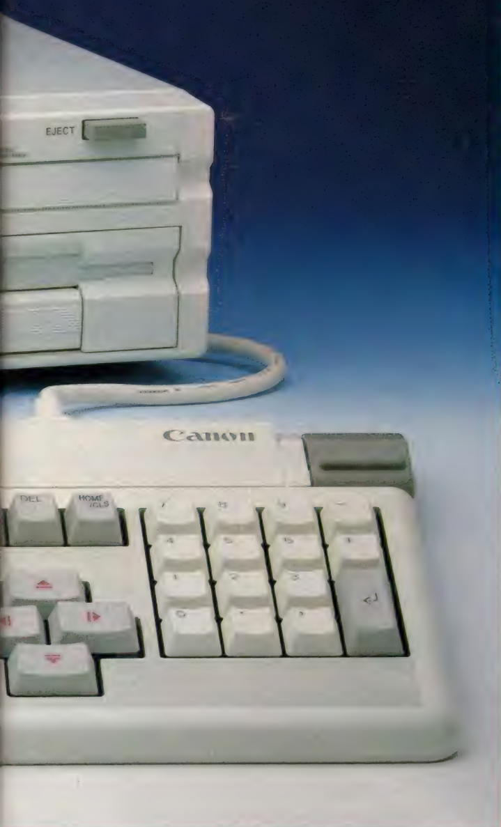
◆使いやすくレイアウトされたキーボード。ステップスカルプチャー・タイプのものを使用。
