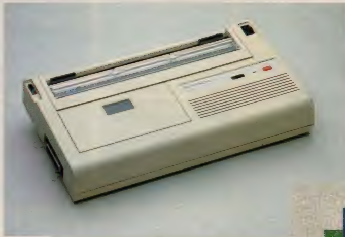
カラープリンタ・MPP-1022H。 MPP-1022Hには2種類のインクリボンが付属する。ひとつは、一般的なブラック。もうひとつがカラ印字のためのものだ。カセットの取り換えはごく簡単。下の絵は前ページの「絵はがき用ワープロ」で描いた画面をカラーコピーしたものだ。かなりの表現力があるといえよう。
