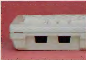
◆本体手前に設けられたジョイスティック・ポート。キーボードはステップスカルプチャー・タイプだ。
