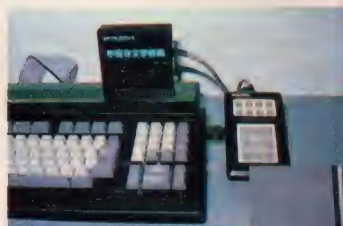
◆参考出品の手書き文字認識カートリッジ。BASICのコマンドも入力することが可能 ◆中央の黒い箱がAVアダプタ。ML-G10につなげることで、テレビなどの機能が使えるようになる。
