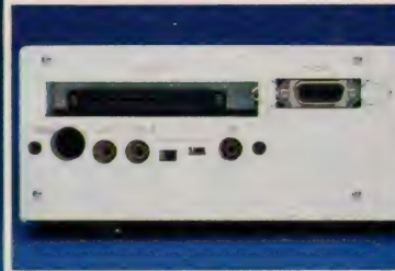
◆後面にある第2スロット。オーディオ端子横のカラー切り換えて、カラーとモノクロ映像の選択が可能。
