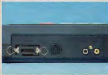
◆左からプリンタ・インターフェイス、カセット・インターフェイス、オーディオ出力、ビデオ出力。
