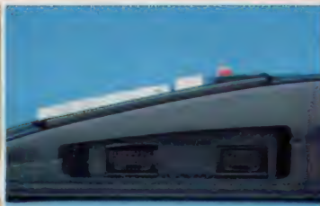
◆キーボードはステップスカルプチャータイプ。右側面にジョイスティック・ポッドがある。
