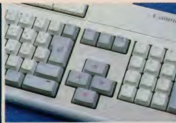
◆使いやすくレイアウトされたキーボード。ステップスカルプチャー・タイプのものを使用。
