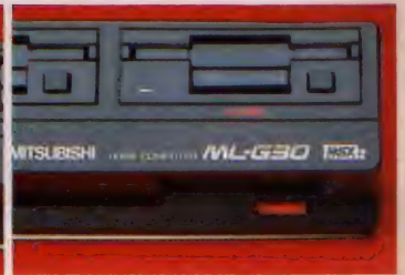
◆2DD方式で1メガバイトの記憶容量を達成したフロッピーディスク・ドライブ。写真はドライブ1。
