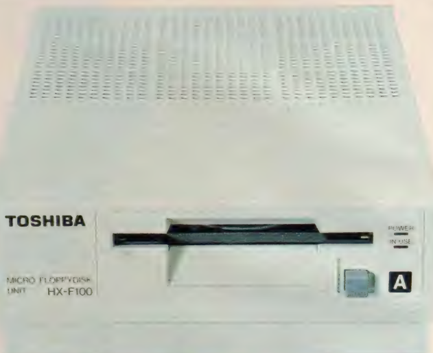
▲東芝のHX-F100は、1DDのディスクドライブ。このドライブで読めるのは1Dと1DDのディスクのみ。2Dや2DDは読めない。
