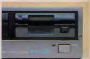
◆記憶容量1メガバイトのフロッピーディスク・ドライブ。使用のメディアは、もちろん3.5インチだ。
