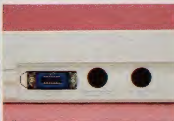
◆左から、プリンタ1F、カセット1F、そしてアナログRGB出力の各コネクタ。
