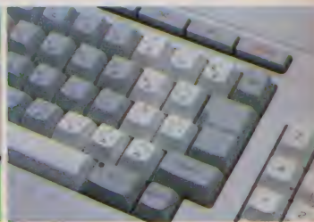
◆質の良い、ステップスカルプチャータイプのキーボード。テンキーの配置等は「HB-F5」と同じ。
