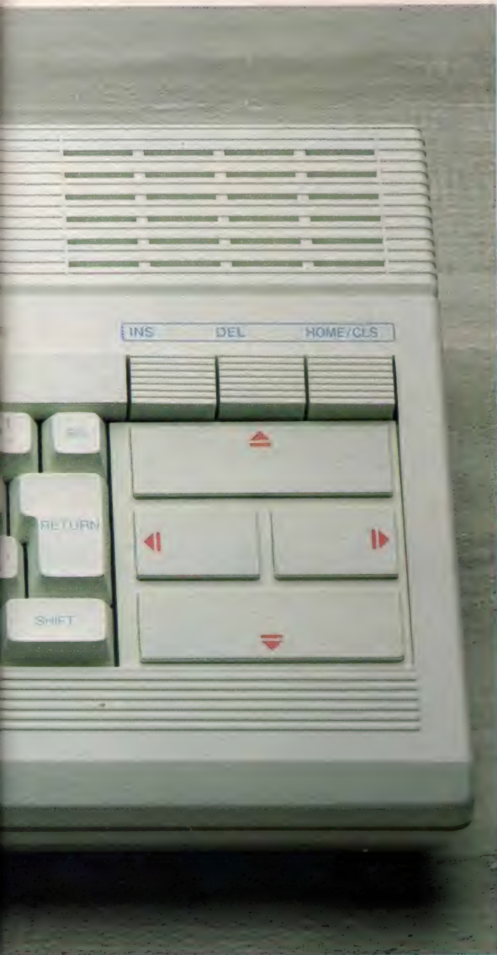
◆本体手前に設けられたジョイスティック・ポート。キーボードはステップスカルプチャー・タイプだ。
