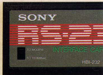
▲スイッチを切り換えることで、ケーブルの接続を変えられる。
