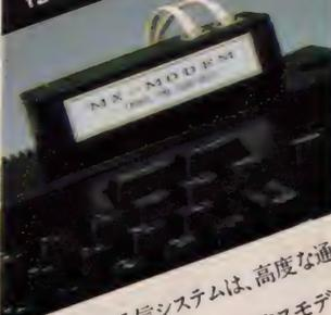
ザ・リンクスの通信システムは、高度な通信ソフトをROMに搭載したリンクスモデムを、あなたのパソコン本体(MSX)に差し込み、家庭の電話に接続するだけの簡単なシステムです。従来のカプラーを使ったシステムと比べて、RS232Cインターフェイスを不要とし、価格は約4倍と大幅に安く、通信スピードは4倍の1200bpsと高速です。また、独自に開発した高性能通信
