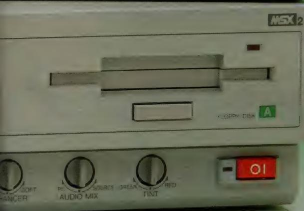
ビデオ・グラフィックスからワープロ・システム、さらにはテレ・コミュニケーションまで。およそコンピュータで考えられるすべての機能を可能にしてしまったのが、このビクターの「HC-95」だ。スーパー・インポーズ可能、記憶容量1メガバイトのフロッピーディスク・ドライブを2機内蔵した、スーパーMSX2マシンの登場だ。
