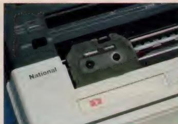
▶24ドットのプリンタヘッド。サーマル（熱転写）タイプなので、印字音もとっても静かだ。
