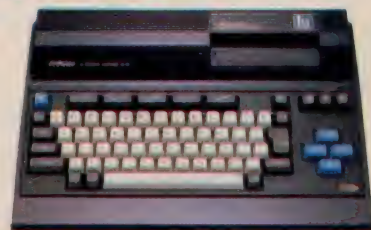
VRAM128キロバイト、気軽にMSX2の充実グラフィックスが楽しめる。音とグラフのソフトも内蔵。
