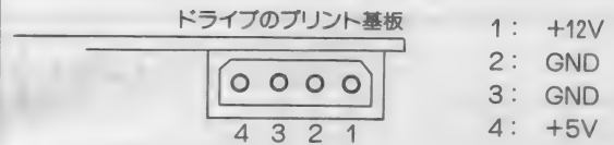
図3 電源コネクタの接続
