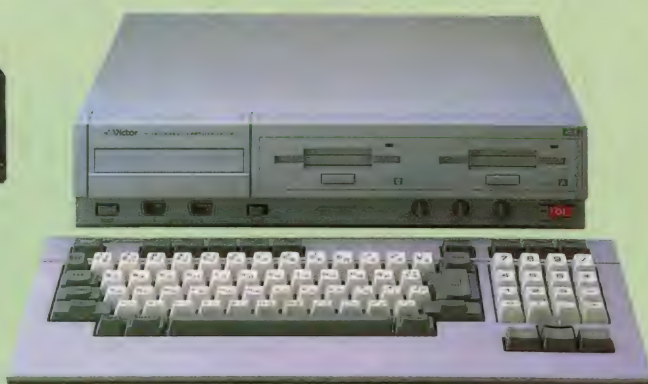
◆ターボモードで処理速度が2倍！ RS-232Cもついている。"HC-95"でした。
