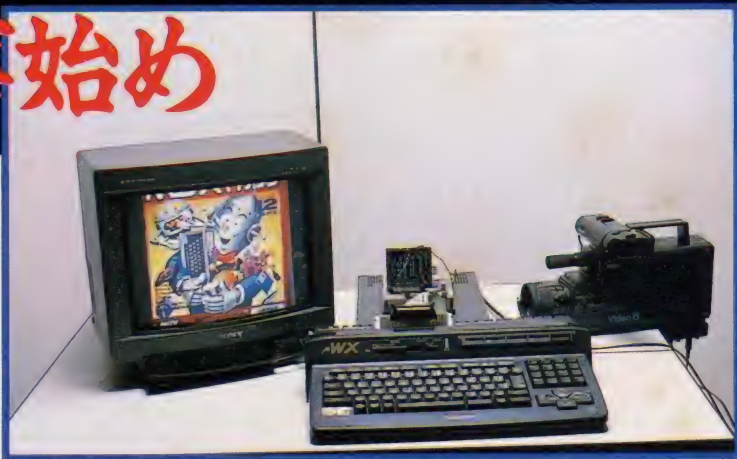
◆システム全体だ。動画を取り込むために、SONYのデジタルビデオアダプターを使っている。
