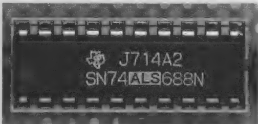
■74ALS688。秋葉原価格で、370円。8ビットの入力ポートが2つあり、その値が同じになったときにフラグを立てる。
