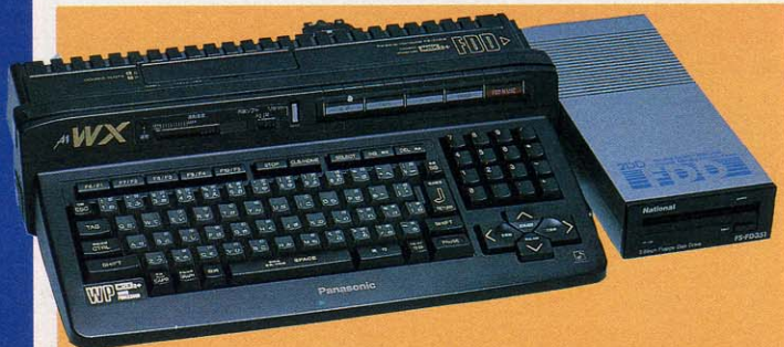
▲ドライブを増設し、メインRAMを256キロバイトにしたFS-A1WXの姿だ。へへー。
