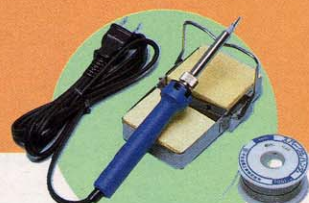
◆なるべくセラミックタイプのこてを使おう。15~20ワット程度が最適だ。
