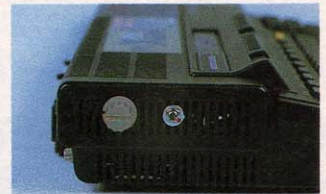
▲キット基板から線を引っ張って、本体の左側にボリュームをつける。
