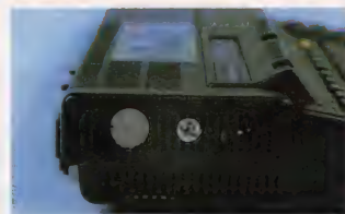
●キット基板から線を引っ張って、本体の左側にボリュームをつける。
