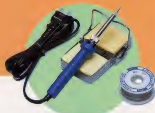
◆なるべくセラミックタイプのこてを使おう。15~20ワット程度が最適だ。
