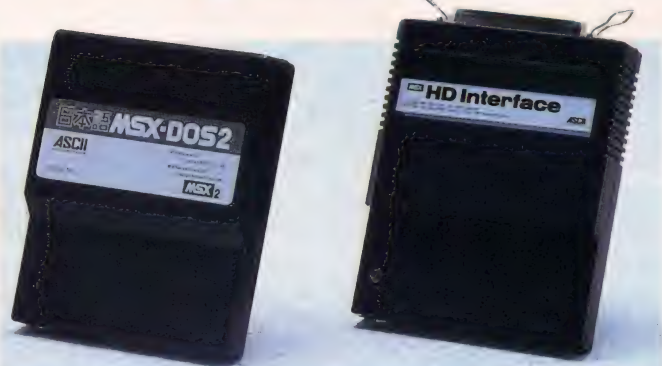
▲左が256キロバイトのRAMを内蔵したDOS2カートリッジ。右は通信販売のハードディスクインターフェイスなのだ。
