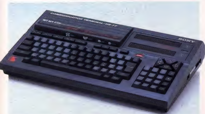
▲1200bpsの通信モデムを内蔵して話題になったソニーのHB-T7。
