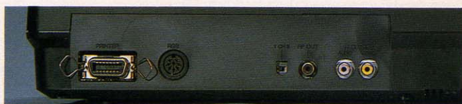
◆スラットと並んだ背面のコネクタ類。オーソドックスです。RGB出力は欠かせないね。
