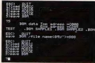
▲BGMデータの先頭アドレスは、最初に表示されているアドレスからCCFFHの間に設定しなければいけない。
