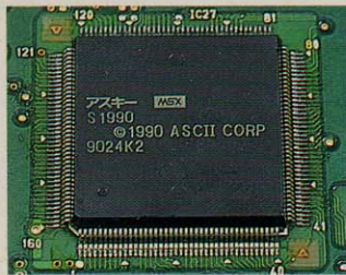
▲ふたつのCPUを切り替えたりといった作業をこなすS1990、turbo Rのために開発されたシステムチップなのだ。
