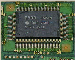
▲これがR800CPUそのもの。100ピンのフラットパッケージに収められている。非常にコンパクトで驚いてしまった。
