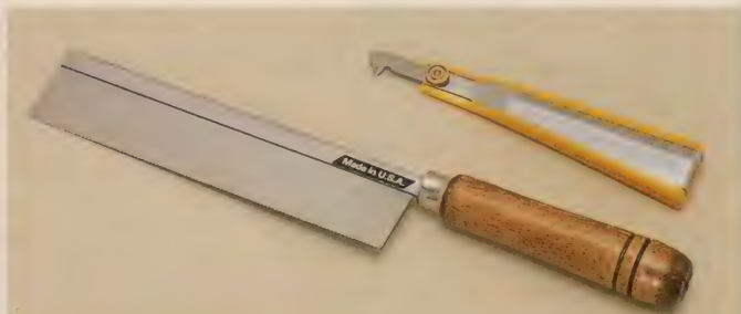
●ケースの加工に使ったPカッターとピラニアのこぎり。糸ノコでもいいけど、真っ直ぐ切るのが難しいよ。
