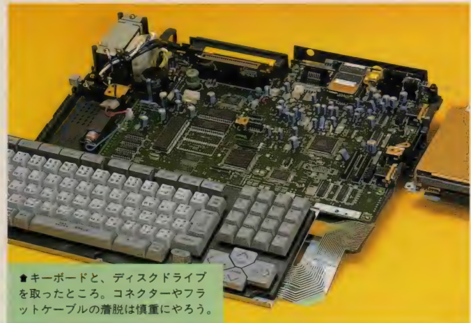
◆マシンの裏側のビスを外すと、タが取れる。キーボードの奥に、緑色をした基板が見えてきたぞ。
