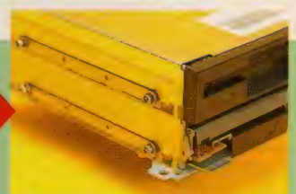
◆ふたつのドライブは板とネジ、両面テープで固定。写真ではアクリル板を使用。
