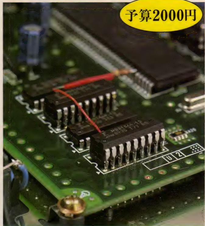
● 恐怖のビデオRAM 2 段重ねの図。ハンダ付けの技術が問われる改造といえるね。
